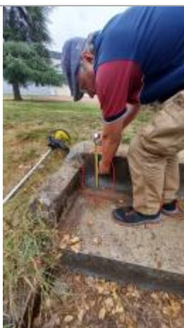
Laisse de crue à 14 cm/sol.
