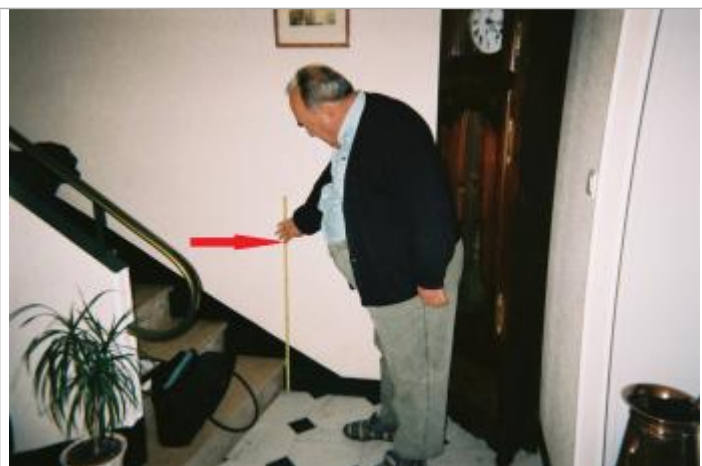
relevé du niveau de l'inondation à l'intérieur de la maison
